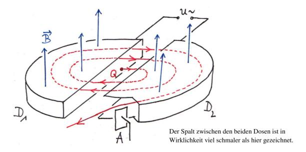
An den zwei dosenförmigen Elektroden D<sub>1</sub>, D<sub>2</sub> (so genannte Duanden) liegt eine Wechselspannung sehr hoher Frequenz f. Das zugehörige elektrische Feld wirkt nur zwischen den beiden Duanden, im Innern der Dosen dagegen verschwindet die elektrische Feldstärke (Faraday-Effekt).
