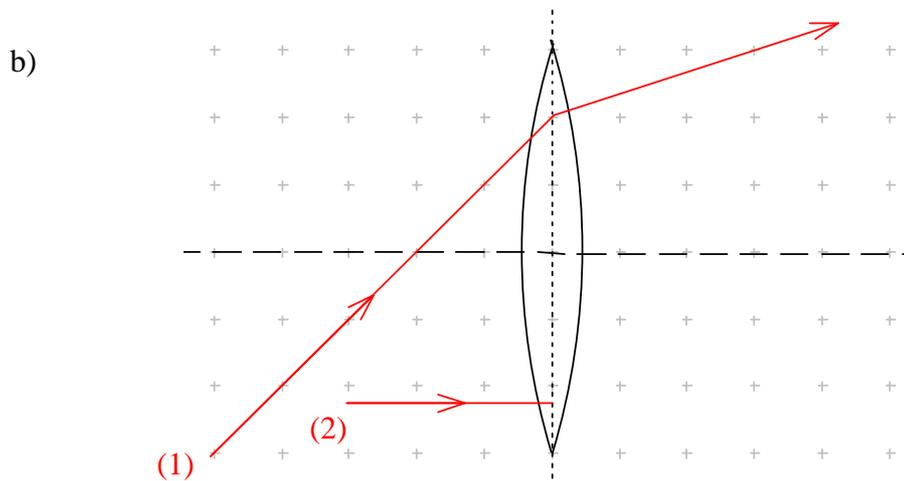
2. Zeichne sauber und möglichst genau das scharfe Bild des Pfeils, das von der Sammellinse in einer Ebene hinter der Linse erzeugt wird.
