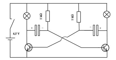
Welcher Zusammenhang besteht zwischen der Größe der Widerstände und der "Stabilitätsdauer" des Kippzustandes? Versuche dein Ergebnis zu begründe
