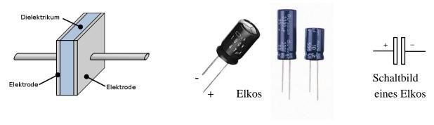
Die auf dem Kondensator gespeicherte Ladung Q hängt von der angelegten Spannung U ab. Man definiert die so genannte Kapazität C des Kondensators durch
