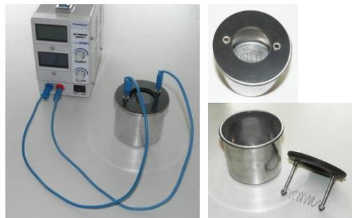
Zum Heizen wird die Spannung auf 10,0V eingestellt und die dabei sich einstellende Stromstärke I (ca. 1,9A) notiert. (Bei leicht schwankenden Werten für I Mittelwert bilden.)
