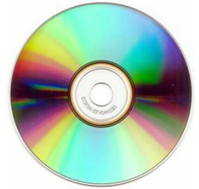
1. Bei der Betrachtung einer Compact-Disc (CD) fällt auf, dass sie einfallendes Licht spektral zerlegt. Ihre Oberfläche enthält winzige Rillen, die ein Reflexionsgitter bilden. Das Licht eines Lasers ( $\lambda = 633\text{nm}$ ) wird senkrecht auf eine CD gerichtet. Das Interferenzmaximum zweiter Ordnung tritt dann gerade unter dem Winkel  $37,7^\circ$  bezüglich der Rillenebene der CD auf.
