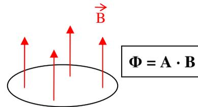
Durchsetzt das Magnetfeld die Leiterschleife unter einem Winkel  $\varphi$  zur Flächensenkrechten (auch Flächennormale  $\vec{n}$  genannt), so wird für den magnetischen Fluss  $\Phi$  nur die senkrechte Komponente von  $B$  verwendet, also
