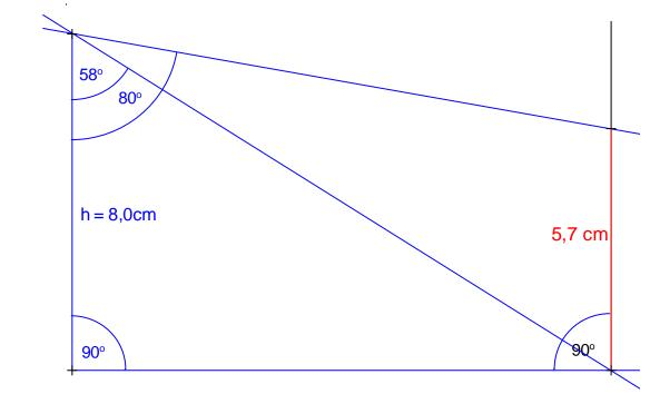
h= 40m; in der Zeichnung: h= 40m: 500 = 4000 cm: 500 = 8,0 cmIn der Zeichnung hat der Baum eine Höhe von 5,7 cm, das entspricht in Wirklichkeit einer Baumhöhe von  $5,7 \text{cm} \cdot 500 = 5,7 \cdot 5 \text{m} = 28,5 \text{m}$ .
